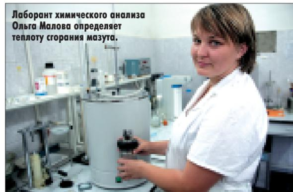
Лаборант химического анализа Ольга Малова определяет теплоту сгорания мазута.
